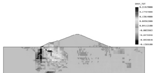
Fig. 15. Diagramme de l'effort \sigma_{xy} au pas 100 (Pa)
